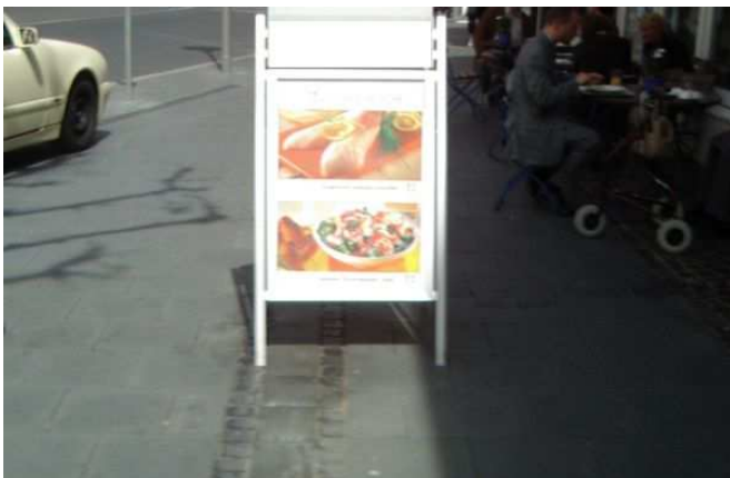
Bild: Aufsteller blockiert die Leitlinie
