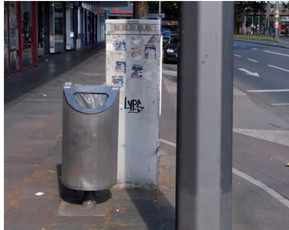
Die Leuchtdichten der einzelnen Elemente unterscheiden sich nur ungenügend von der Leuchtdichte des Bodenbelages und bergen Auflaufgefahren. Eine optische Absicherung durch eine kontrastreiche Markierung wäre auf allen Objekten mit Klebefolien oder Lacken oder durch Bodenindikatoren realisierbar.
